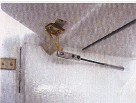
33. УСТАНОВИТЕ СЕРЬГУ СЕРВОМАШИНКИ РУЛЯ ВЫСОТЫ, ХОД ПОД УГЛОМ – 20 мм
