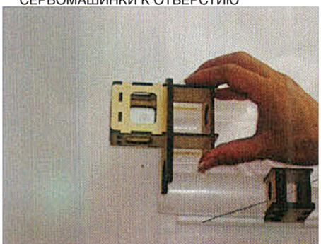
8. НАНЕСЕНИЕ КЛЕЯ НА СТОЙКУ ДВИГАТЕЛЯ И ПОСЛЕДУЮЩЕЕ ПРИКЛЕИВАНИЕ СТОЙКИ
