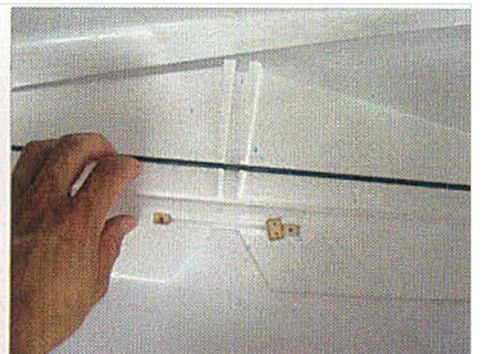
16. ПРИКЛЕЙТЕ ТРУБКУ ИЗ УГЛЕВОЛОКНА К КАНАВКЕ НА ГОРИЗОНТАЛЬНОМ ХВОСТОВОМ ОПЕРЕНИИ
